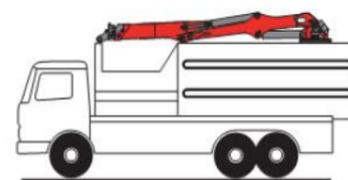
Montažom dizalice na krov smečara štedi se na prostoru za ugradnju. Omogućava kraći međuosovinski razmak, odnosno veći korisni volumen utovarnog prostora.
